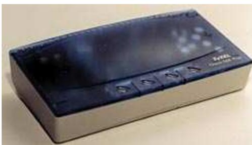
ZyXEL Omni 56K Plus. Как и его старший брат, этот модем также аппаратно адаптирован к российским условиям. В своей работе модем использует высокоскоростные протоколы передачи V.90 и V.92. Обновления микропрограмм можно бесплатно получить на сайте технической поддержки ZyXEL. Модем базируется на наборе микросхем ZyXEL M4. Микропрограмма хранится в флэш-памяти модема, поэтому никаких проблем с установкой новой прошивки не возникнет.
