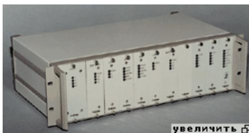
Для тестирования модемов использовался имитационно-измерительный комплекс ANCOM CANAL-5 фирмы «Аналитик-ТС». Он предназначен для проведения автоматизированных испытаний телекоммуникационного оборудования путем имитации электрических характеристик:
