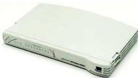
Кроме стандартного последовательного интерфейса RS-232 модем располагает разъемом USB, что расширяет его возможности подключения к компьютеру. На задней стороне корпуса модема имеются два разъема RJ-11 - для соединения с линией и телефонным аппаратом. Здесь же находятся кнопки включения питания и кнопка "Конфигурация" (в прежних версиях модемов вместо нее устанавливалась панелька DIP-переключателей).
