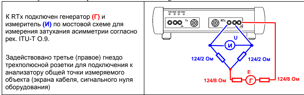
Рис. 1. Эквивалентная схема анализатора в режиме измерения затухания асимметрии
