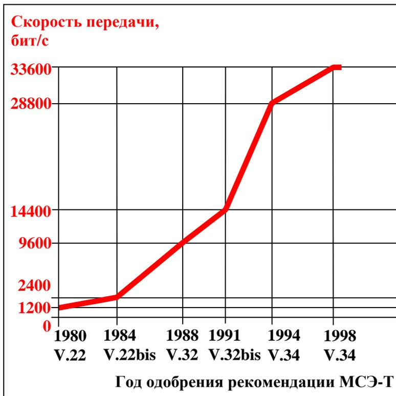
Столь стремительный рост скоростного потенциала модемов может приводить к парадоксальному ограничению возможностей доступа. Так скоростные ограничения, вызванные недостаточным качеством телефонных каналов, делают крайне затруднительной работу приложений, ориентированных на максимально возможную скорость передачи.
