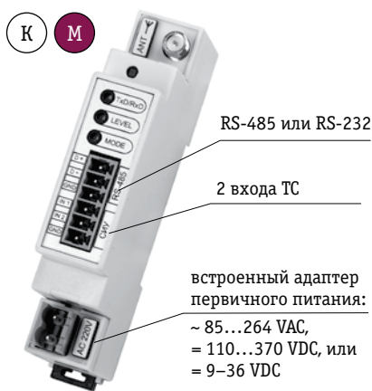
Рис. 2. ZigBee Pro модем AnCom RZ/B. Крепление на DIN рейку. Диапазон температур: -40...+70°C
