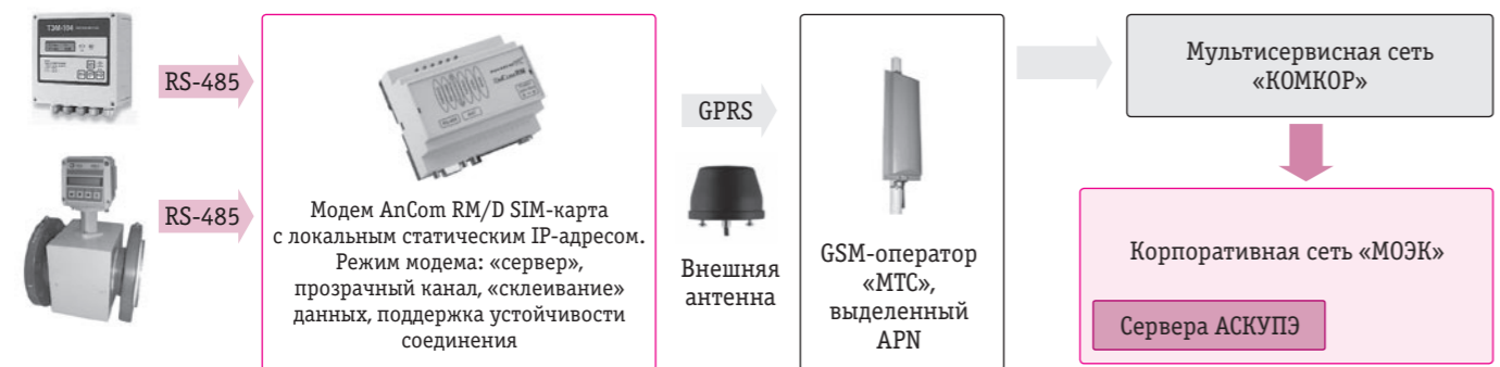
Рис. 1. Схема организации GPRS-канала АСКУПЭ
