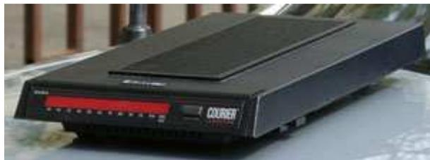
Широко известный модем фирмы 3Com. Выпускается с 1994 года. Нам было интересно взять его в качестве образца "не нового, но хорошо зарекомендовавшего себя" модема. За годы, прошедшие с начала выпуска, в его микропрограмму внесено большое количество исправлений и улучшений. Максимально поддерживаемые модемом скорости работы постоянно росли: сначала 28800 бит/с, потом 33600
