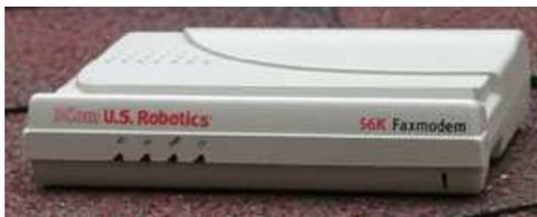
Самый простой модем из новой линейки фирмы 3Com. Позиционируется фирмой, как устройство для домашнего использования, в отличие, например, от серии Office Connect. Стабильно работал на всех смоделированных линиях, демонстрируя при этом более чем достойные результаты. Модем не имеет "фирменных" протоколов передачи данных, голосовых функций и режима
