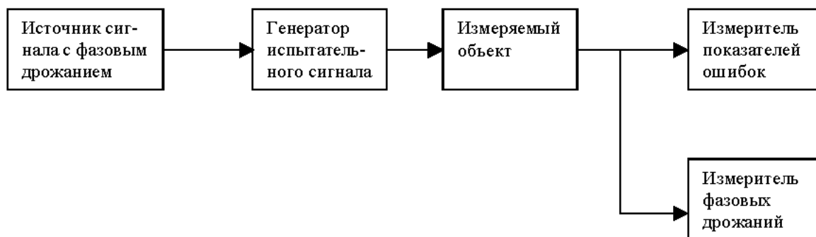
Рисунок 4. Схема измерения допустимых входных дрожаний фазы
