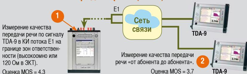
1 Измерение качества передачи речи по сигналу TDA-9 в КИ потока E1 на границе зон ответственности (высокоомно или 120 Ом в ЗКТ).
