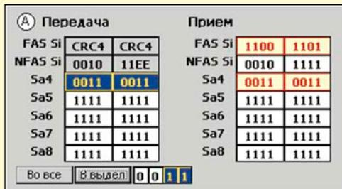
Контроль Sa-битов возможен в двух направлениях, подключенных к входам E1-A, E1-B.
